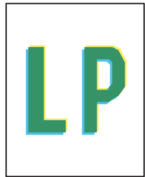
6-12. tabula. Krāsu shēmas reģistrēšanas defekti (tikai krāsu modeļiem) 78. lpp.
