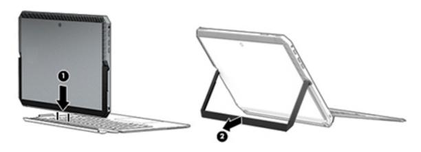
営 注記:キックスタンドを閉じている場合、キーボードを取り付けたままキーボードを回転させて、 キーボードの背面がタブレットの背面に接触した状態で固定できます。キーボードがこの位置にあ る間は、キーボードのキーおよびタッチパッドがロックされ、誤入力が防止されます。
