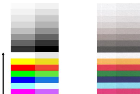
Às vezes, a incompatibilidade de cores entre módulos adjacentes pode ser enorme, mostrando um sério malfuncionamento do scanner, como no exemplo a seguir.
