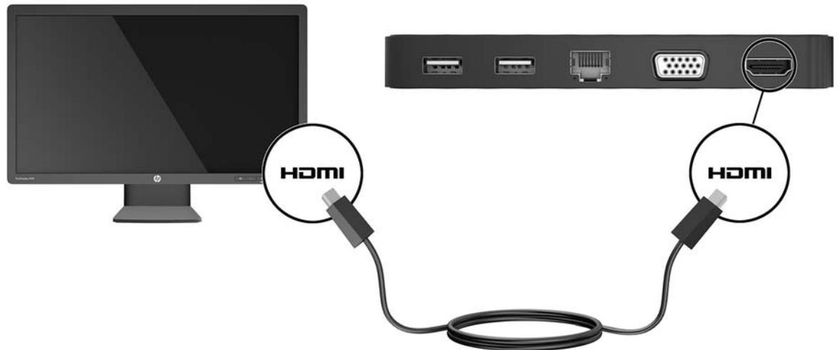
2. Schließen Sie das andere Ende des Kabels an den High-Definition-Fernseher bzw. -Monitor an.
