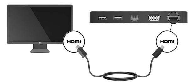
Conecte el otro extremo del cable a un TV o monitor de alta definición.
