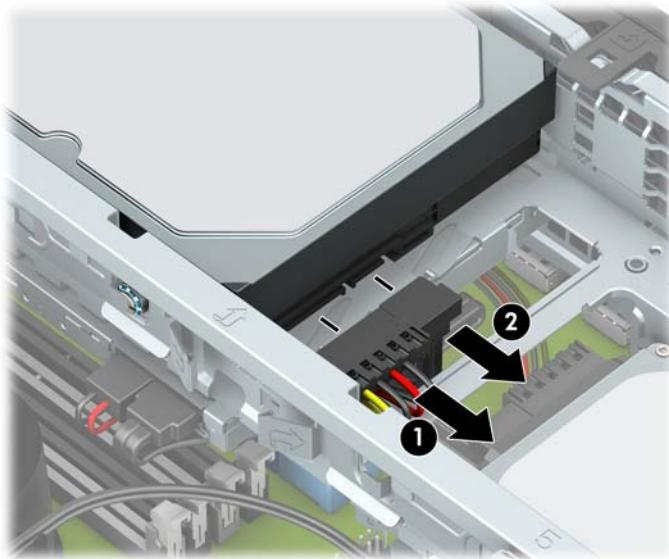
8. 将硬盘驱动器后端旁边的释放杆往外拉 (1)。在拔出释放杆时，将驱动器的后端向上抬起 (2)，然后将驱动器的前端向后滑动并将其从驱动器托架中取出 (3)。
