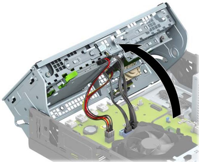
9. 从硬盘驱动器背面断开电源电缆 (1) 和数据电缆 (2)。
