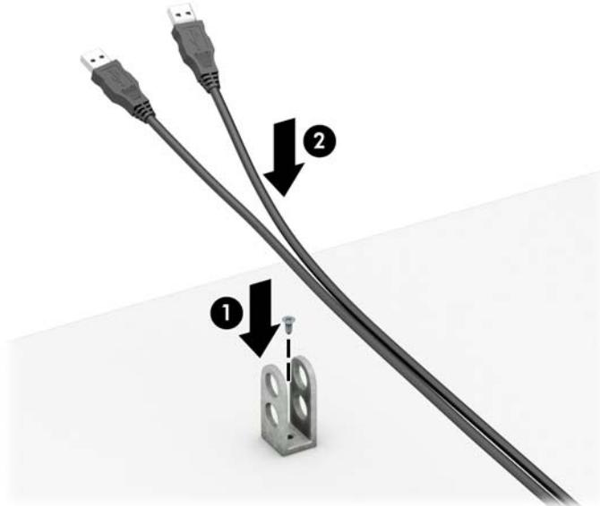
7. 将安全保护缆锁穿过附件电缆紧固件的小孔。
