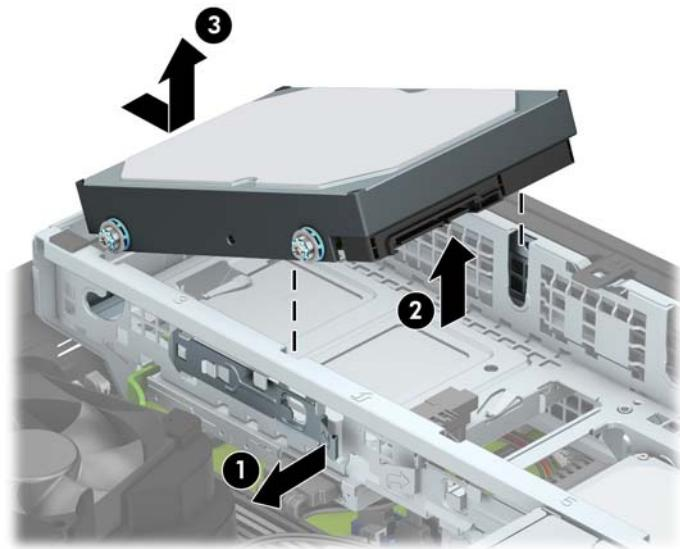
9. 卸下旧驱动器上的四个安装螺钉（每侧两个）。安装新驱动器时将要用到这些螺钉。
