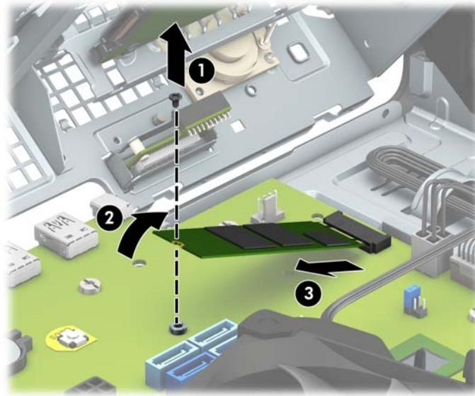
10. 要安装 M.2 SSD 卡，以大约  $30^{\circ}$  的倾角将卡上的针脚插入主板连接器 (1)。按下卡的另一端 (2)，然后用螺钉将卡固定 (3)。
