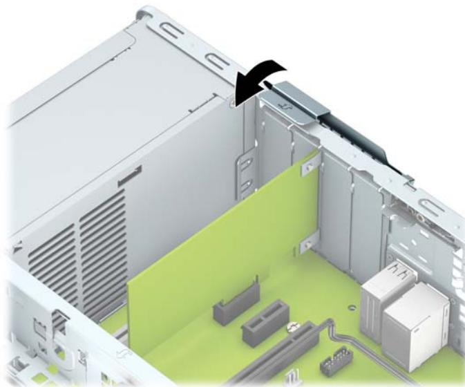
**14.** 如果需要，将外部电缆连接到已安装的卡上。如果需要，将内部电缆连接到主板上。
