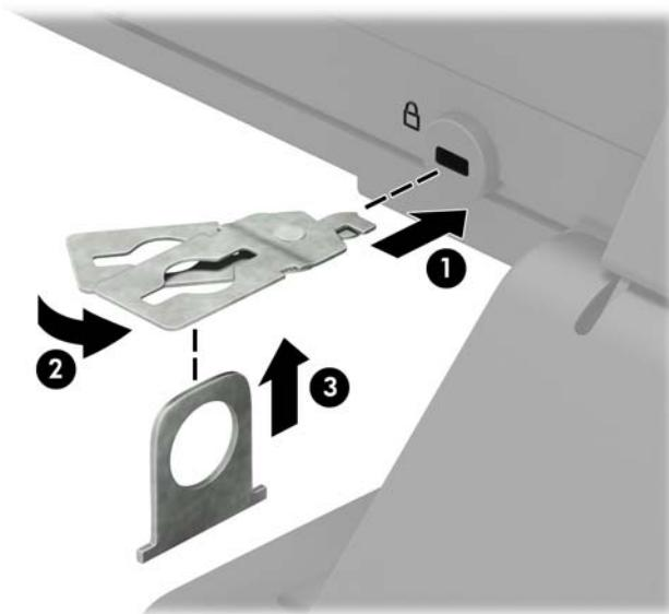
5. 将安全电缆穿过安装在显示器上的安全保护指南。
