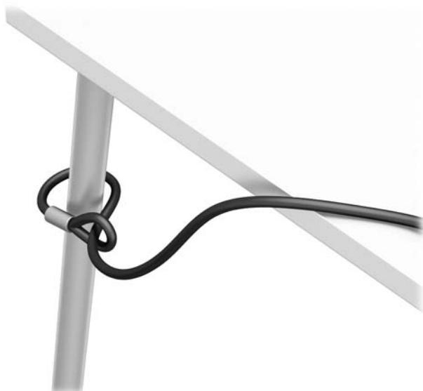
3. 将安全保护缆锁穿过安全保护缆锁紧固件。
