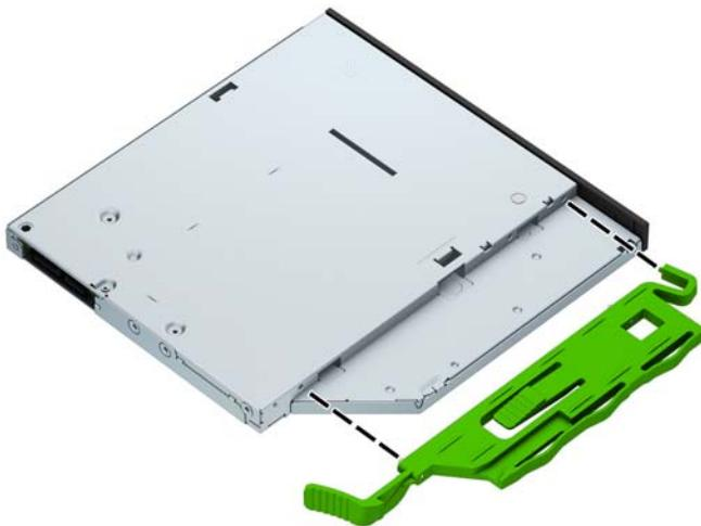
9. 将光驱通过前面板径直推入托架中(1), 直到光驱背面的栓锁锁定到位(2)。
