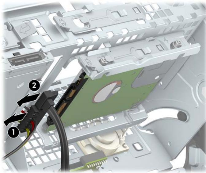
10. 将驱动器后端的释放杆往外拉 (1)。然后，将驱动器向后滑动直到滑不动为止，然后向下拉，使其脱离驱动器托架 (2)。
