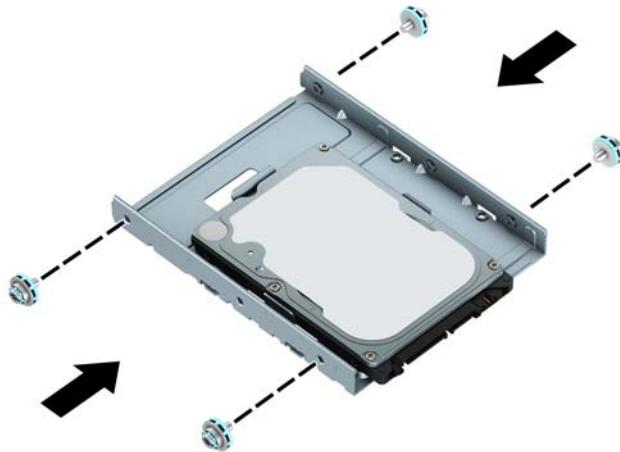
8. 将硬盘驱动器前端的安装螺钉与驱动器箱上的插槽对齐，然后将驱动器的前端向下按并向前推入托架 (1)。然后将驱动器的后端向下按入驱动器托架 (2)，将其锁定到位。
