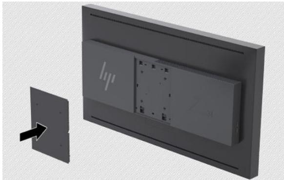
3. Para montar a cabeça do monitor diretamente numa peça de suporte, utilize os quatro parafusos removidos dos orifícios VESA na parte posterior do monitor e instale-os para fixar o dispositivo de montagem à parte posterior do ecrã.
