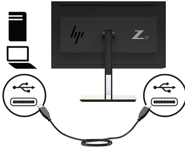
4. Ligue uma extremidade do cabo USB incluído à porta USB a jusante no painel traseiro do computador e a outra extremidade ao conector USB a montante do monitor.
