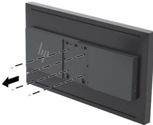
2. Instale a tampa de chapa posterior incluída sobre os parafusos de montagem na parte posterior do monitor.
