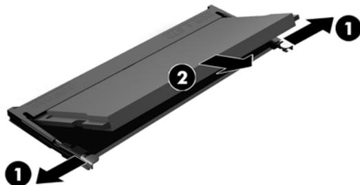
4. Deslize o novo módulo de memória (1) para dentro da ranhura a um ângulo de aproximadamente 30° e, em seguida, pressione o módulo de memória para baixo (2) de modo a que os fechos encaixem na posição.
