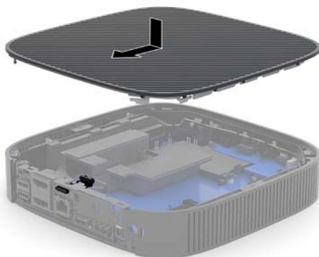
2. 将后 I/O 面板 (1) 左侧的挂钩插入机箱背部的左侧，然后朝机箱方向旋转右侧 (2) 并将其按入机箱，直至其卡入到位。
