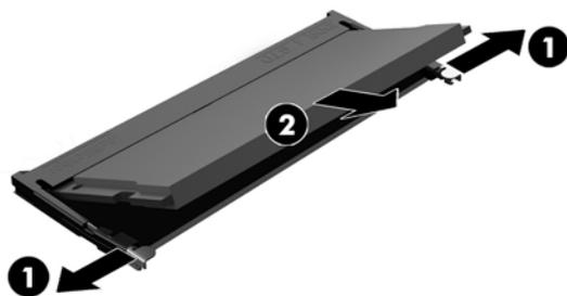
4. 將新的記憶體模組 (1) 以大約 30° 角滑入插槽，然後將記憶體模組往下壓 (2)，讓卡榫鎖入定位。
