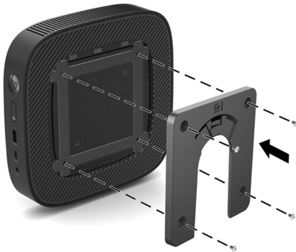
5. 使用裝載裝置套件中所附的四顆螺絲，將 HP 快速釋放的另一側連接到您要安裝精簡型電腦的裝置。確定釋放桿的點朝上。
