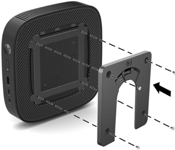
5. 장착 장치 키트에 포함된 4개의 나사를 사용하여 HP Quick Release의 다른 한쪽 면에 썬 클라이언트를 장착할 장치를 연결합니다. 분리 레버 포인트가 위로 향해 있는지 확인합니다.
