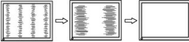
3. クロックを調整しても画面にかすみ、ちらつき、線などが表示される場合は、続いてフェーズを調整します。
