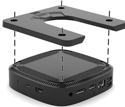
4. À l'aide de quatre vis fournies avec le kit de montage, fixez l'autre côté du support de fixation HP Quick Release sur le dispositif sur lequel vous voulez installer le client léger. Veillez à ce que le levier de déverrouillage soit orienté vers le haut.
