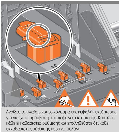
Ανοίξτε το πλαίσιο και το κάλυμμα της κεφαλής εκτύπωσης για να έχετε πρόσβαση στις κεφαλές εκτύπωσης. Κοιτάξτε κάθε εκκαθαριστές ρύθμισης και επαληθεύστε ότι κάθε εκκαθαριστές ρύθμισης περιέχει μελάνι.
