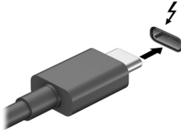
2. Verbinden Sie das andere Ende des Kabels mit dem externen Thunderbolt Gerät.
