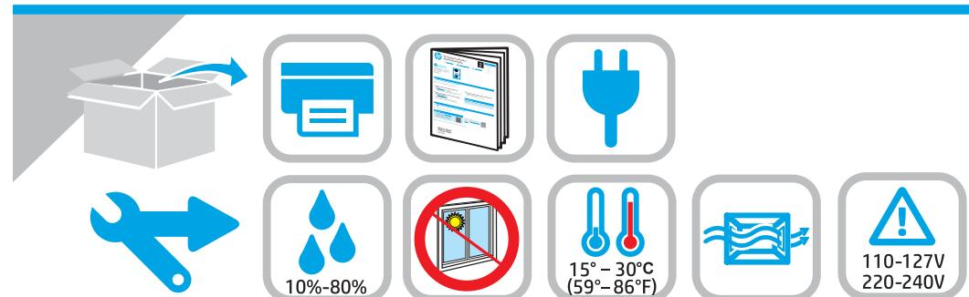
חבר את כבל המתח למדפסת ולשכע AC מוארך, ולאחר מכן הפעל את המדפסת. וזה שמקורה המתח מתאים לדיווג המתח של המדפסת. דיווג המתח .50/60 Hz בתיווחת המדפסת. המדפסת משתמשת במתח של 100-127 וולט AC או 220-240 וולט AC וטדרו 50/60 Hz.
