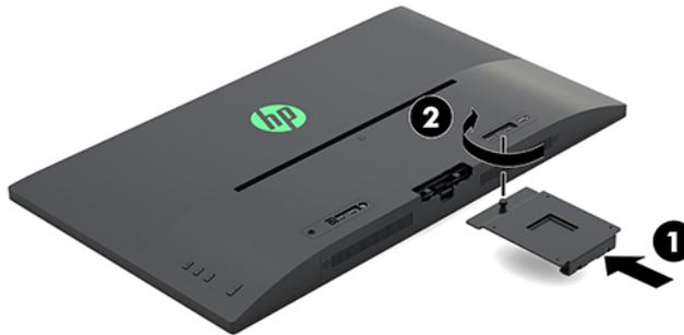
4. Para fijar al monitor a un brazo oscilante u otro dispositivo de montaje, inserte cuatro tornillos de montaje en los orificios del dispositivo de montaje y dentro de los orificios para tornillos del soporte VESA instalado en la parte trasera del monitor.
