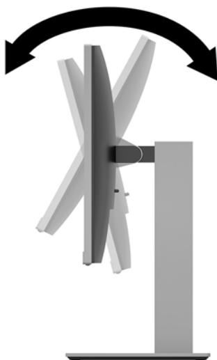
2. モニターパネルを左または右に回転させて、最適な表示角度に設定します。
