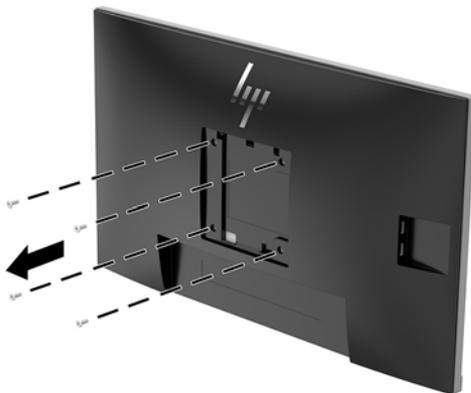
2. モニターパネル背面にある VESA 基準の取り付け穴から取り外した 4 本のネジを使って、マウントプレートを所定の壁またはスイングアームに取り付けます。
