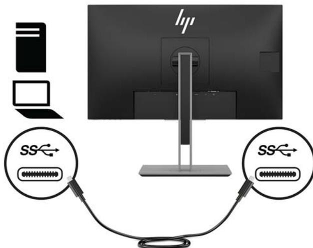
5. ケーブルをモニターの後面の USB アップストリームポートに接続します（ディスプレイの USB Type-A ポートにデータを転送します）。
