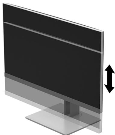
4. 必要に応じて、モニターパネルの表示方向を横向きから縦向きに回転できます。
