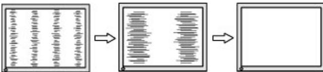
4. クロックを調整しても画面にかすみ、ちらつき、線などが表示される場合は、続いてフェーズを調整します。
