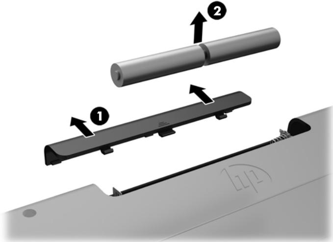
Per rimuovere le batterie dal mouse senza fili, rimuovere lo sportello delle batterie sul lato inferiore del mouse (1) ed estrarre le batterie dal vano batterie (2).
