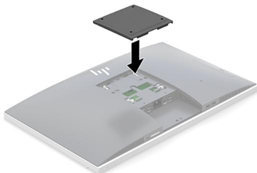
2. Per collegare il computer ad un braccio snodabile (venduto separatamente), inserire le quattro viti da 20 mm fornite in dotazione con il computer attraverso i fori sulla piastra del braccio snodabile e nei fori di montaggio sul computer.
