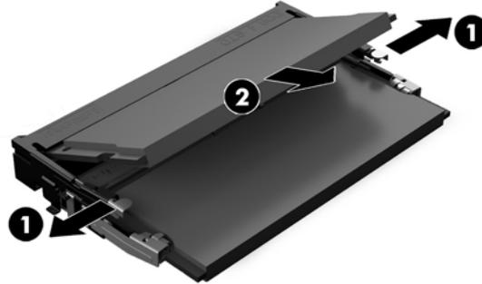
4. Deslize o novo módulo de memória (1) para dentro do slot num ângulo de aproximadamente 30° e, em seguida, pressione o módulo de memória para baixo (2) de forma que as travas se encaixem corretamente.
