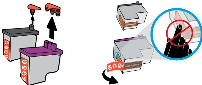
Remova os tampões da parte superior dos cabeçotes de impressão e remova a fita dos contatos utilizando as abas.
