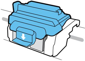
**IMPORTANT!** Mantenha a trava azul fechada após a instalação do cabeçote de impressão.
