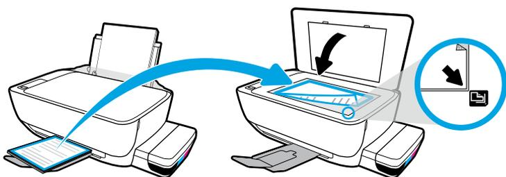
Τοποθετήστε τη σελίδα ευθυγράμμισης στη γυάλινη επιφάνεια του σαρωτή.
