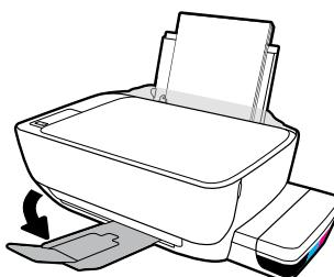
Выдвиньте входной лоток. Загрузите обычную белую бумагу и отрегулируйте направляющую. Выдвиньте выходной лоток и его удлинитель.
