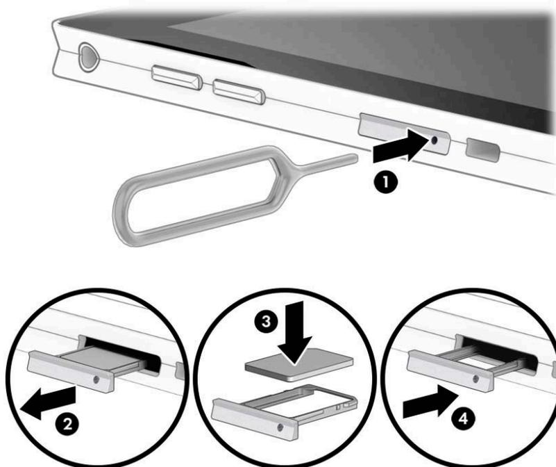
Um die SIM-Karte zu entfernen, führen Sie die Schritte in umgekehrter Reihenfolge aus.
