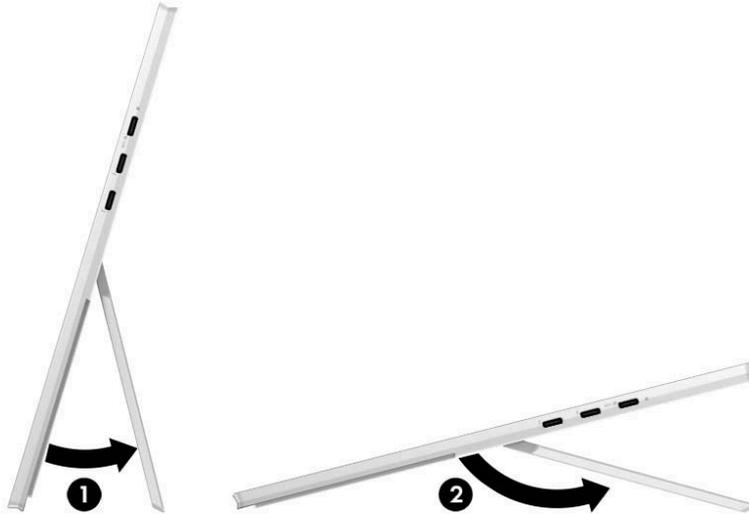
Um den Ständer zu schließen, schieben Sie den Ständer zum Tablet hin, bis er bündig mit der Unterseite ist.
