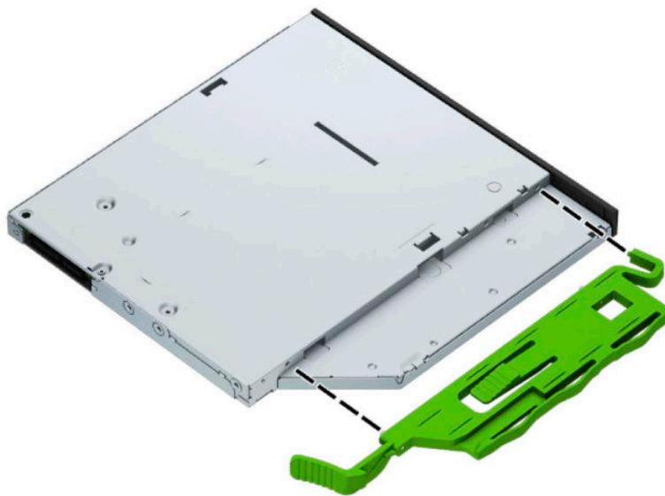
8. Deslize completamente a unidade ótica ao longo do painel frontal para o interior do compartimento (1) de forma que o fecho na parte posterior da unidade encaixe na posição (2).
