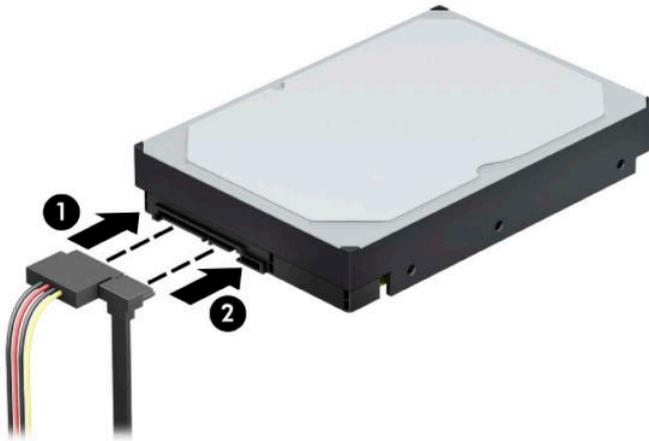
11. Se estiver a instalar uma unidade nova, ligue a extremidade contrária do cabo de dados ao conector adequado da placa de sistema.
