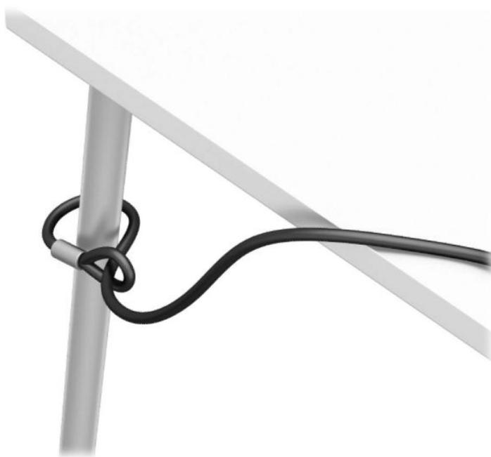
3. Faça deslizar o cabo de segurança através do fixador do cabo de segurança.
