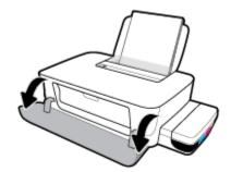
**b.** Abra a porta de acesso aos cabeçotes de impressão. Mantenha o botão **Continuar** ( ) pressionado por cerca de três segundos. Aguarde o carro de impressão ir para o centro e parar.
