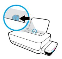
3. Insira a pilha de papel de pequenas dimensões (como papel fotográfico) na lateral direita da bandeja de entrada, com a margem curta voltada para baixo, e o lado de impressão voltado para cima. Deslize a pilha de papel para baixo até que ela pare.
