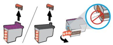
NOTA: Não toque nos contatos elétricos do cabeçote de impressão.
