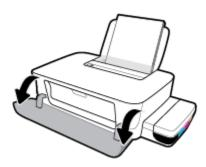
**b.** Abra a porta de acesso aos cabeçotes de impressão. Mantenha o botão **Continuar** () pressionado por cerca de três segundos. Aguarde o carro de impressão ir para o centro e parar.
