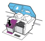
Remova da abertura o cabeçote de impressão que você deseja substituir.
