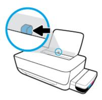
Insira a pilha de papel na bandeja de entrada com a borda curta voltada para baixo e o lado a ser impresso voltado para cima. Deslize a pilha de papel para a frente até que pare.
