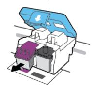
**f.** Verifique se há um tampão na parte superior do cabeçote ou fita plástica nos contatos do cabeçote. Remova qualquer tampão e fita do cabeçote de impressão.
