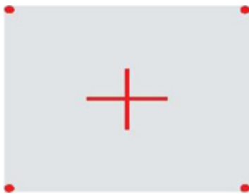
Figure 4-2 Taille relative et emplacement du modèle de système de visée
