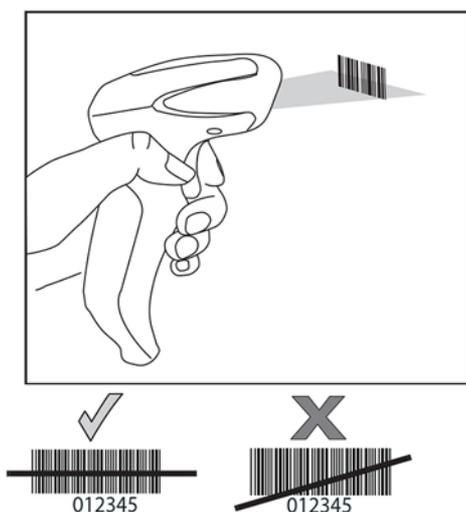
Ne tenez pas le scanner directement au-dessus du code-barres. La lumière se reflétant directement en direction du scanner depuis le code-barres est qualifiée de réflexion spéculaire. Cette réflexion spéculaire peut compliquer le décodage. Dans ce cas, vous pouvez incliner le scanner jusqu'à 65° vers l'avant ou vers l'arrière et réussir le décodage.
