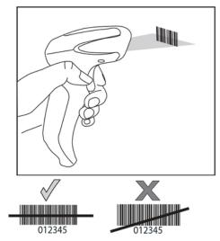
No sostenga el escáner directamente sobre el código de barras. La luz que se refleja directamente al escáner desde el código de barras se conoce como reflexión especular. Esta reflexión especular puede tornar difícil la decodificación. Usted puede inclinar el escáner hasta 65° hacia adelante o hacia atrás y lograr una decodificación con éxito.
