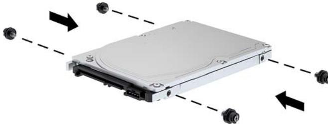
8. Schließen Sie das Kabel an der Rückseite der Festplatte an (1). Richten Sie die Montageschrauben am Laufwerk nach den J-förmigen Schlitten an den Seiten des Laufwerksschachts aus und drücken Sie dann das Laufwerk in den Laufwerksschacht hinein. Schieben Sie dann das Laufwerk vorwärts, bis es einrastet (2).
