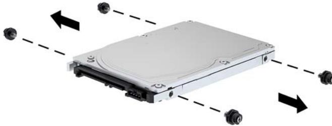
7. Montieren Sie die vier Befestigungsschrauben, die Sie aus dem alten Laufwerk entfernt haben, in den Seiten der neuen Festplatte.
