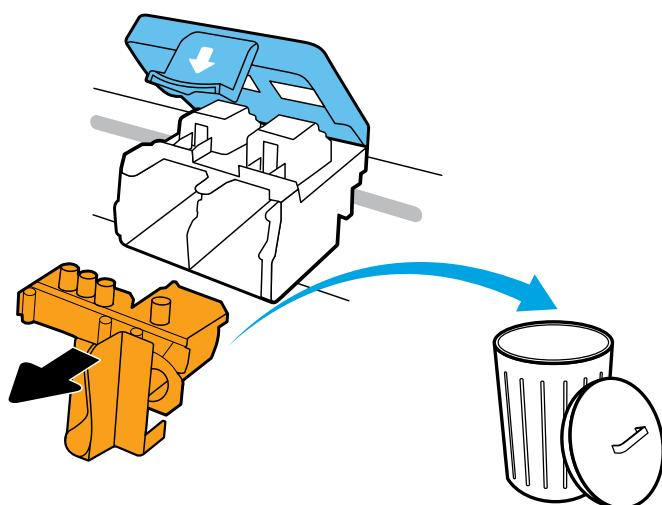
**PL** Naciśnij niebieski zatrzask, aby otworzyć. Usuń pomarańczowy, plastikowy element i wyrzuć go. Zachowaj ostrożność, aby unknąć rozlania atramentu.
