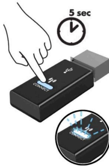
4. Mientras el indicador luminoso de estado del receptor está parpadearo, presione el botón Conectar en la parte inferior del teclado de cinco a diez segundos. Después de soltar el botón Conectar, el indicador luminoso de estado del receptor dejará de parpadear, indicando que los dispositivos se han sincronizado.
