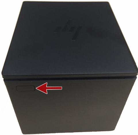
Se a trava estiver presa e não for possível abrir a tampa, não force a trava. Se isso acontecer, segure a impressora de cabeça para baixo, localize a alavanca de liberação da trava e puxe-a em direção à lateral do chassi para soltar a trava. Assim, a tampa superior se abrirá.
