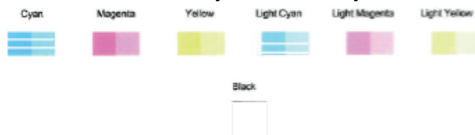
Obrázek 8-2 Příklad barevných bloků s defekty
