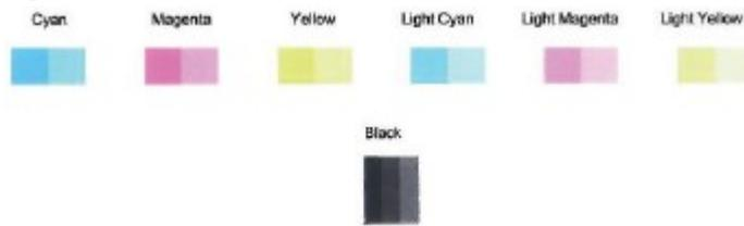
**Figura 8-2** Esempi di blocchi di colore con difetti
