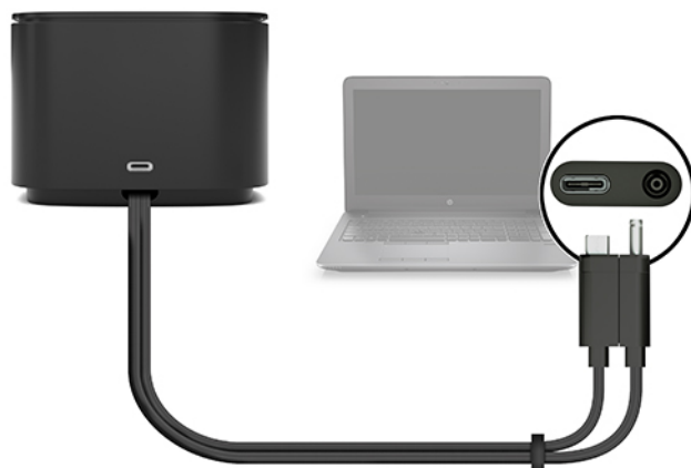
Figure 1-4 Connexion à un connecteur d'alimentation USB de type C et au port Thunderbolt via le câble combiné
