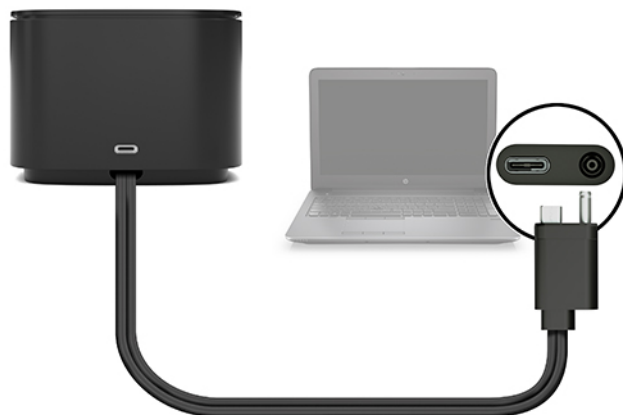
Figura 1-2 Collegamento a un connettore di alimentazione USB Type-C e a una porta Thunderbolt
