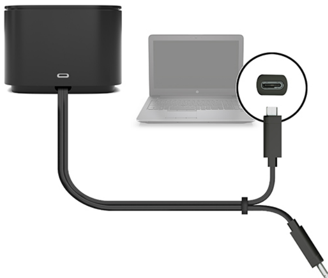
Figur 1-4 Tilslutning til et USB Type-C-strømsstik og en Thunderbolt-port via kombinationskablet
