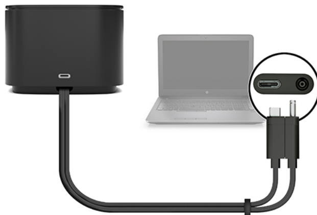
Figur 1-4 Tilslutning til et USB Type-C-strømsstik og en Thunderbolt-port via kombinationskablet
