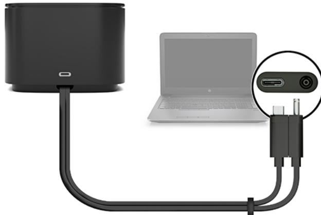
**Figura 1-4** Ligar a um conector de alimentação USB Type-C e à porta Thunderbolt através do cabo combinado
