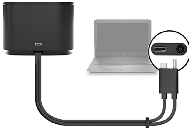
Figura 1-4 Conexão a um conector de alimentação USB Type-C e porta Thunderbolt por meio do cabo combinado
