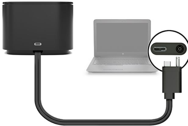
Figura 1-2 Conexão a um conector de alimentação USB Type-C e porta Thunderbolt
