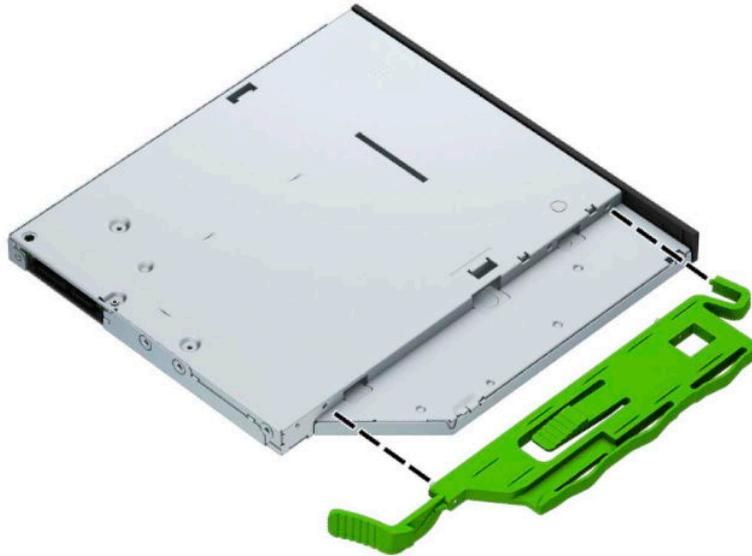
9. Insérez l'unité optique par l'avant du châssis (1) et faites-le glisser complètement à l'intérieur du compartiment jusqu'à ce que le loquet vert s'emboîte dans le châssis (2).
