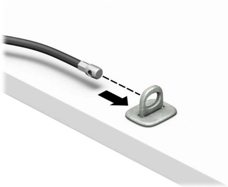
4. Séparez les deux poignets de ciseau du verrou du moniteur et insérez le verrou dans la fente du câble antivol située à l'arrière du moniteur (1), fermez les poignets du ciseau pour fixer le verrou en place (2), puis faites glisser le guide de câble antivol à travers le verrou du moniteur (3).
