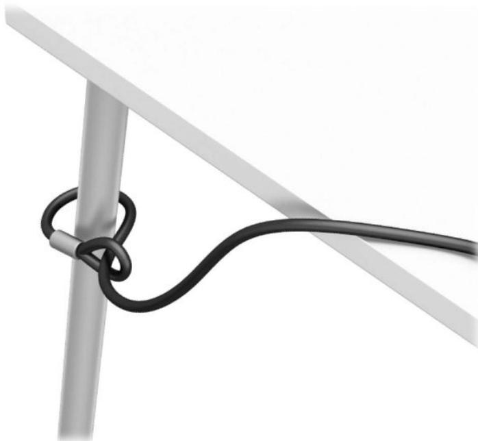
2. Insérez le verrou du câble antivol dans l'emplacement pour câble antivol. Puis, verrouillez-le en place avec la clé.
