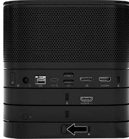
4. 將安全纜線安裝至 VESA 安裝板的安全纜線鎖孔，以避免快速釋放門解除鎖定，造成模組分開。
