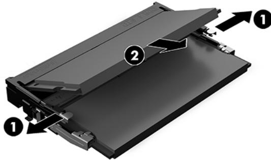
3. 將新的記憶體模組以約 30° 角插入插槽 (1)，然後將記憶體模組向下壓 (2)，讓卡榫將其卡入定位。
