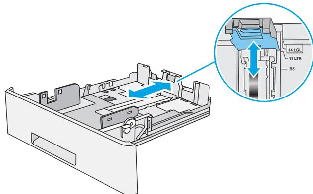
4. Cargue el papel en la bandeja. Asegúrese de que la pila no tenga las esquinas dobladas y que su parte superior no exceda los indicadores de altura máxima.
