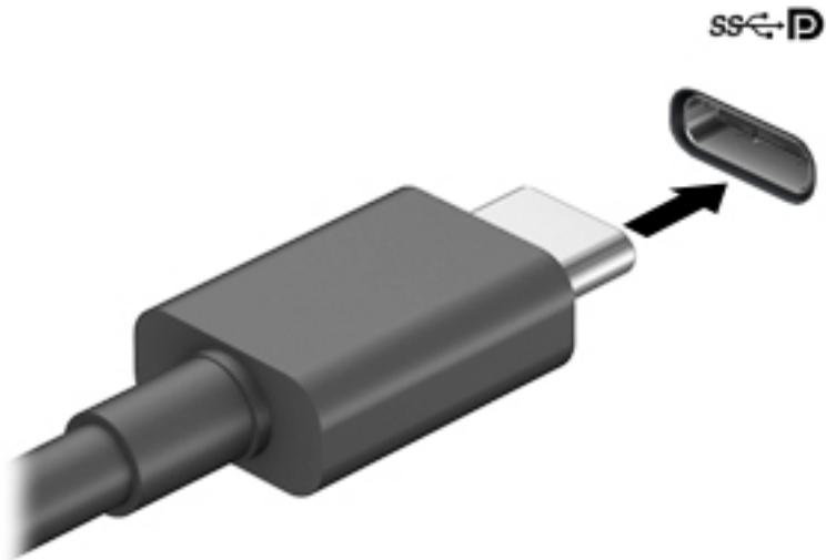
2. ケーブルのもう一方の端を外付けの DisplayPort デバイスに接続します。
