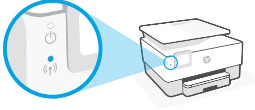
(luz de conexão sem fio) fica acesa, significa que a impressora está conectada à rede sem fio. Caso contrário, veja as soluções a seguir.
