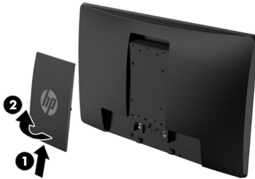
3. Um den Monitor an einem Schwenkarm (separat erhältlich) anzubringen, führen Sie vier 10-mm-Schrauben durch die Bohrungen an der Schwenkarmplatte und drehen sie in die Montagebohrungen am Monitor.
