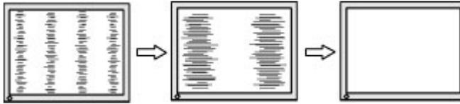
3. Dopo la regolazione dell'Orologio, in caso di sfocatura o sfarfallio o se sullo schermo appaiono delle barre, procedere alla regolazione della Fase.
