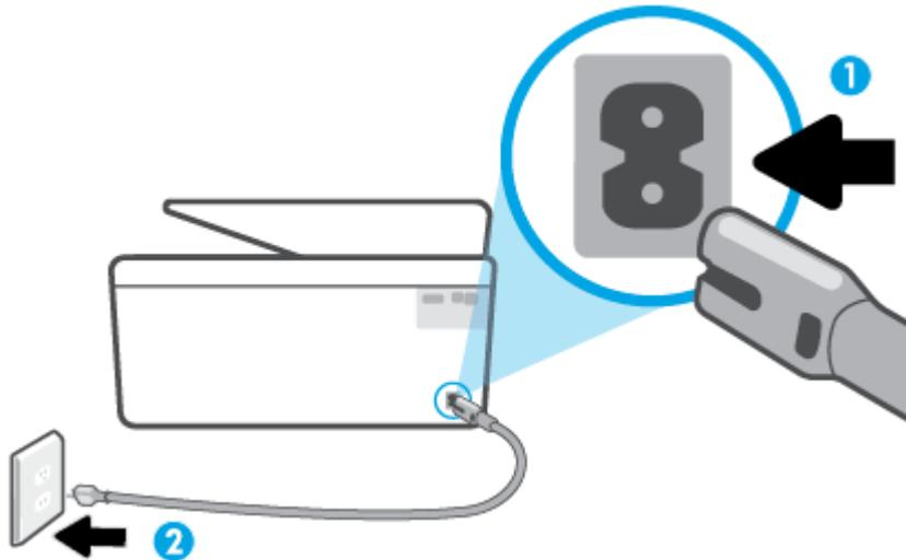
1 Conexão de força à impressora
