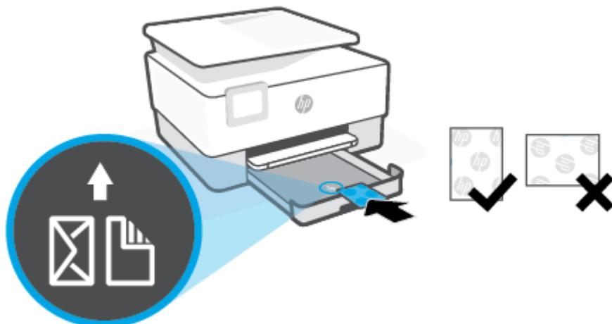
Certifique-se de que a pilha de papel esteja alinhada as linhas apropriadas de tamanho do papel, na frente da bandeja. Além disso, certifique-se de que a pilha de papel não exceda a marcação de altura da pilha na borda esquerda da bandeja.
