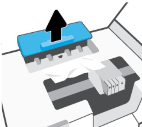
6. 找到打印机中卡住的纸张，用双手抓住纸张向外拉出。
