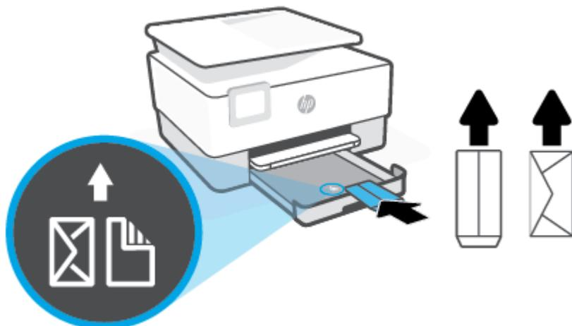
确保纸叠与纸盒前面合适的纸张大小线条对齐。此外，确保纸叠不超过纸盒左边缘上的堆叠高度标记。
