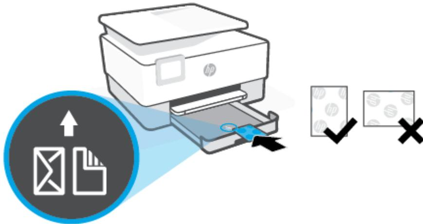
确保纸叠与纸盒前面合适的纸张大小线条对齐。此外，确保纸叠不超过纸盒左边缘上的堆叠高度标记。
