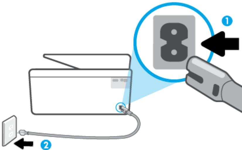
1 连接到打印机的电源
