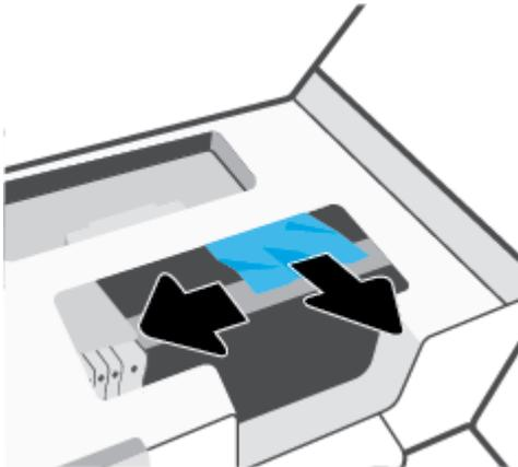
4. 如有必要，请把托架移动到打印机的最右侧，然后取出卡纸或碎纸。
