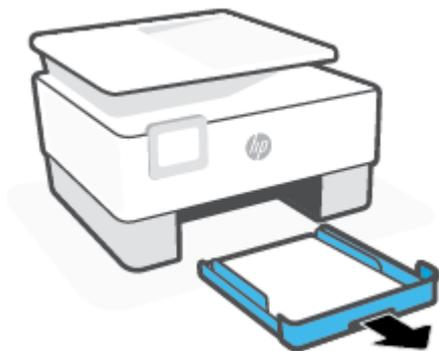
3. 检查打印机下面的进纸盒区域。取出卡住的纸。
