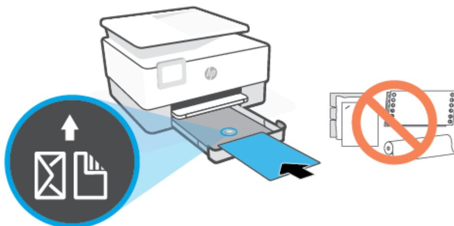
确保纸叠与纸盒前面合适的纸张大小线条对齐。此外，确保纸叠不超过纸盒左边缘上的堆叠高度标记。
